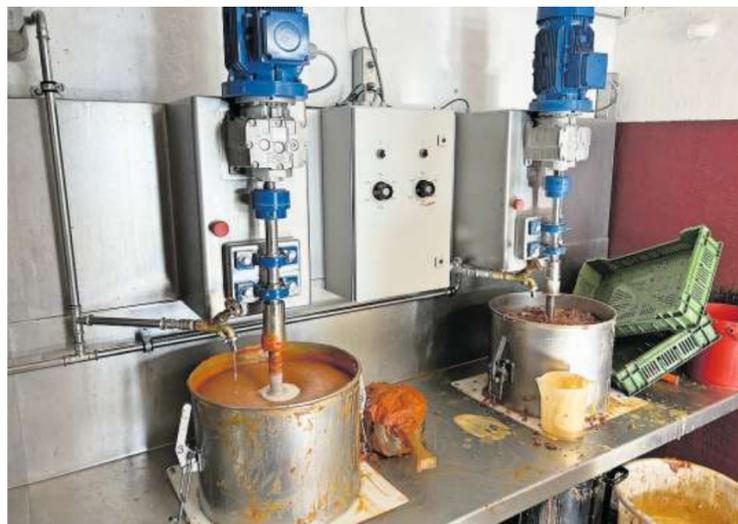
**Siebanlage:** Während rund 30 Minuten werden die Hagebutten durch ein Sieb gepresst. So werden Kerne und Härchen entfernt.
